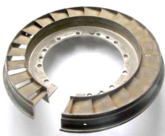
Рис. 6.2. Сопловой аппарат из сплава ВКНА-25 (ФГУП ВИАМ)
