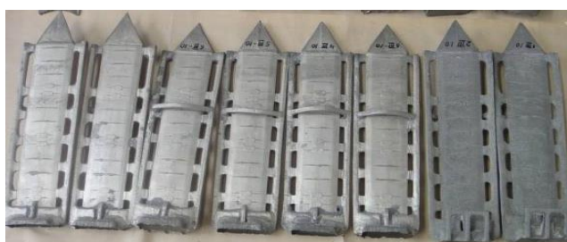
Рис. 5.3. Проставки реактивного сопла из сплава ВКНА-1В (ФГУП ВИАМ)
