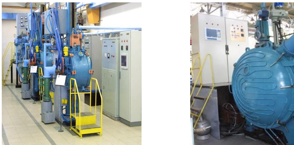
Рис. 2.1 Вакуумная индукционная печь VIM 50 (ALD Vacuum Technologies)
