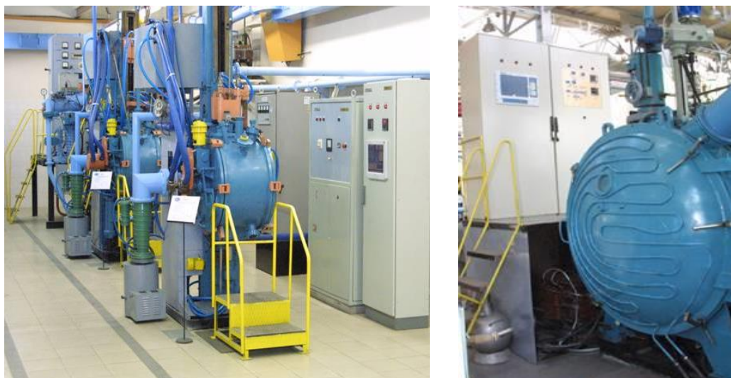
Рис. 3.1 Вакуумная индукционная печь VIM 50 (ALD Vacuum Technologies)
